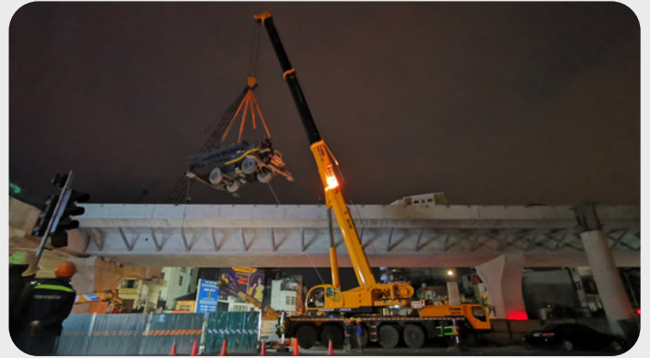
2 Xe cầu hỗ trợ bốc dỡ, vận chuyển hàng hóa công kênh
